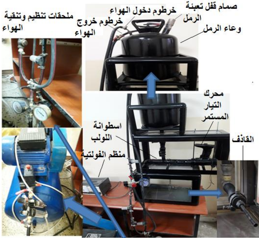
شكل (6): صور فوتوغرافية توضح أجزاء منظومة فحص التعرية.
